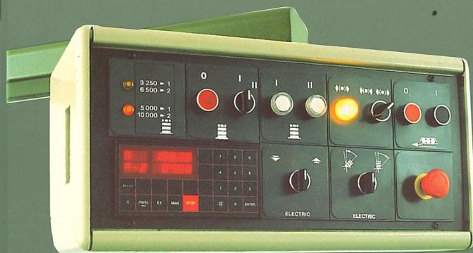
**SONDERZUBEHÖR.** Die vorhandenen Sonderzubehöre machen die Maschine besonders vielseitig: - Zapfenschneidschlitten - Tischverbreiterung zum Profilieren - Elektronische Mikroprozessor-Programmierung mit Kontrolle für 2 Achsen, für Spindelhub und Spindelschrägstellung - Auswechselbare Frässpindel - Schaltpult schwenkbar.
