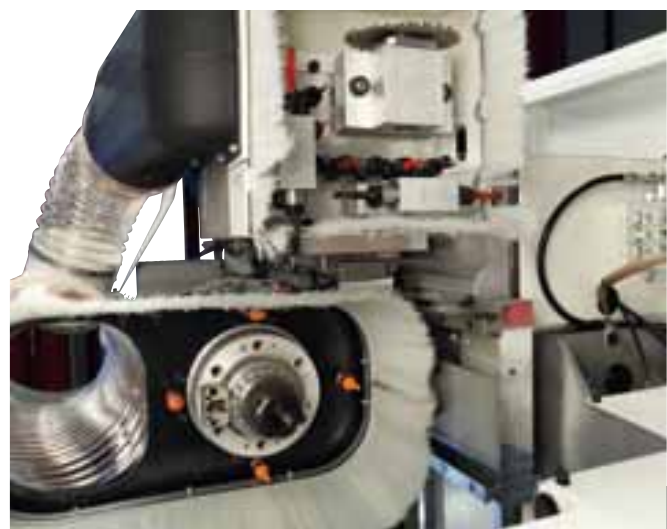
Spezifische Arbeitsaggregate für die Tech z1: • Bohraggregat • 6,6 kW (9 PS) Elekterspindel (Ausführung A) • 9,5 kW (13 PS) Elekterspindel (Ausführung B, C) • nicht-interpolierende Vektor Achse (Ausführung C)
