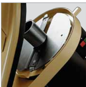
Zwei schräg liegende Wendemesser bringen doppelte Leistung beim Einziehen und Häckseln.
