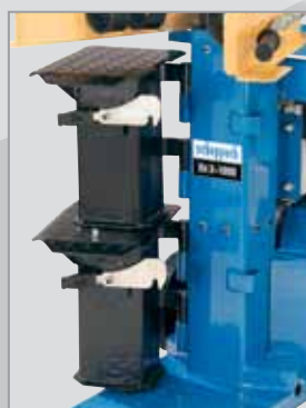
2 ausschwenkbare Tische mit Tischverriegelung.
