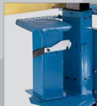
Ausschwenkbarer Zusatztisch mit Tischverriegelung.
