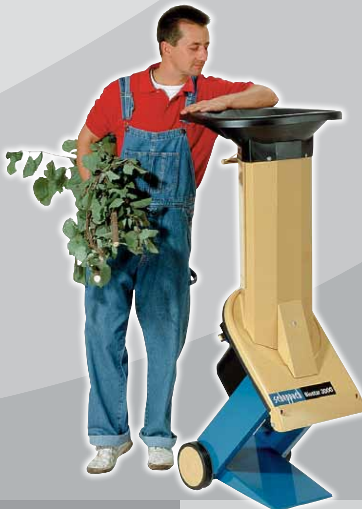
Das Einzug-Schrägschnitt-System mit den Messern im 45-Grad-Winkel ist patentiert und damit konkurrenzlos.
