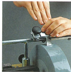
svh 60 Vorrichtung für gerade Schneiden (Standardausstattung)
