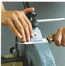
svm 45 Vorrichtung für kleine Messer ab 6 cm Klingenlänge
