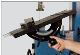
Tischverstellung durch Handrad auch mit einer Hand möglich
