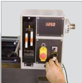
Die variable Drehzahleinstellung ist einfach über einen Drehknopf zu regulieren.
