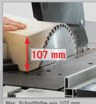
Max. Schnitthöhe von 107 mm
