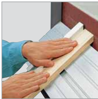
Mit dem Winkelanschlag führen Sie beim Winkelschleifen auch kleine Werkstücke sicher.
