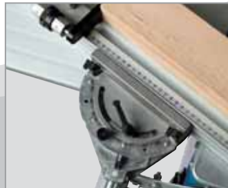
Das große Schwenksegment des Schiebeschlitten professionell (optional) besitzt einen Schwenkbereich von -60^\circ bis +60^\circ
