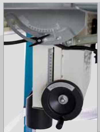
Die Einstellung der Höhe und Schräge sind an Skalen einfach ablesbar.
