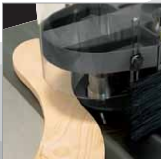
Um geschweifte Werkstücke sicher und präzise zu bearbeiten, ist der Bogenfräsanschlag höhenverstellbar.
