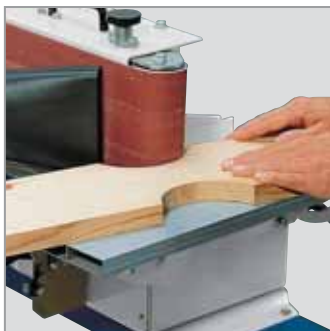
Durch den geringen Durchmesser der Umlenkrolle können Sie enge Innenradien bearbeiten.
