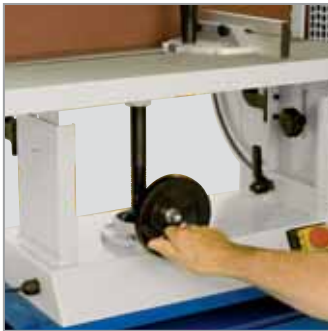
Einfache und exakte Höhenverstellung des Schleiftisches über Handrad und Spindel
