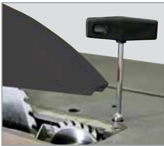
Die Höhen- und Seiteneinstellung des Vorritzers erfolgt einfach und bequem von oben neben dem Säge- blatt. (Werkzeug im Lieferumfang enthalten)
