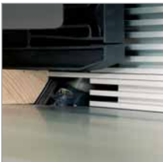
Die Frässpindel ist bis 45° nach hinten schwenkbar.
