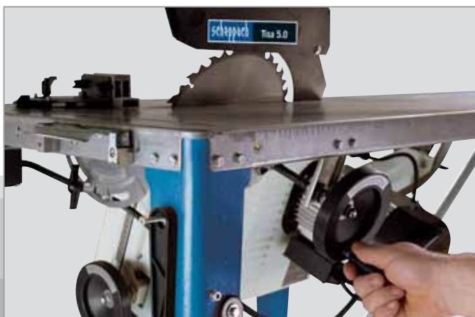
Sowohl die Höhen- als auch die Schrägverstellung erfolgt angenehm und präzise durch zwei eigene Handräder
