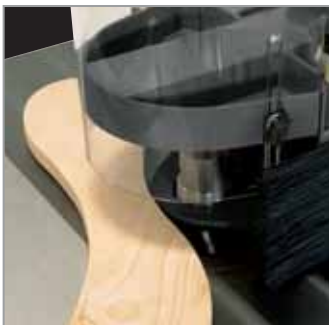
Um geschweifte Werkstücke sicher und präzise zu bearbeiten, ist der Bogenträsanschlag höhenverstellbar.
