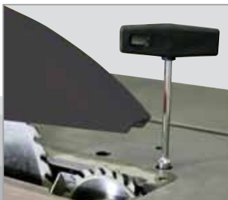
Die Höhen- und Seiteneinstellung des Vorritzers erfolgt einfach und bequem von oben neben dem Säge- blatt. (Werkzeug im Lieferumfang enthalten)
