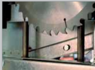
Präzision durch doppelt säulenge- führte Höhenverstellung
