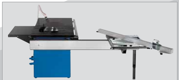
...durch verschieben der Führungsschiene nach vorne, eben mehr Platz vor dem Sägeblatt (sowohl Schiebeschlitten Standard als auch Schiebeschlitten Profiaus- führung).
