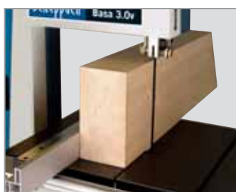
Einzigartige Durchlasshöhe 205 mm und Durchlassbreite 306 mm
