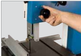
Schnitthöhenverstellung durch Handrad
