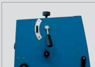
Schnellspannsystem für schnellen Bandsägeblattwechsel
