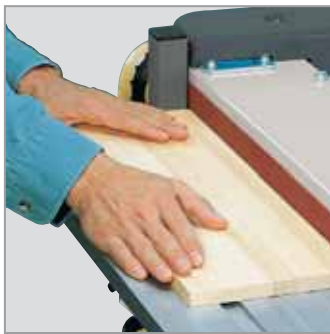
Die stufenlos verstellbaren Tische erlauben gleichmäßige Schriffe an Kanten.
