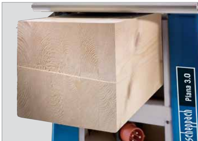
Durchlasshöhe /-breite beim Dickenhobeln: 210 x 250 mm
