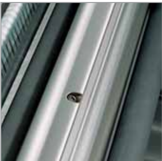
Blick auf die Hobelwelle und die beiden gummierten Vorschubwalzen
