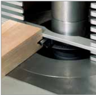
Der Multifunktionsanschlag lässt Sie auch schmale Werkstücke sicher bearbeiten.
