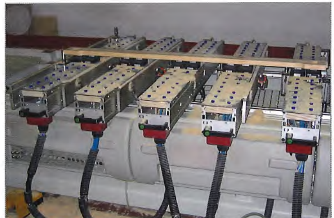
Innospann Steel-Plate | Umrüstung Konsolentisch durch Steel-Plate mit Mono-Bases und diversen Sauger-Cups
