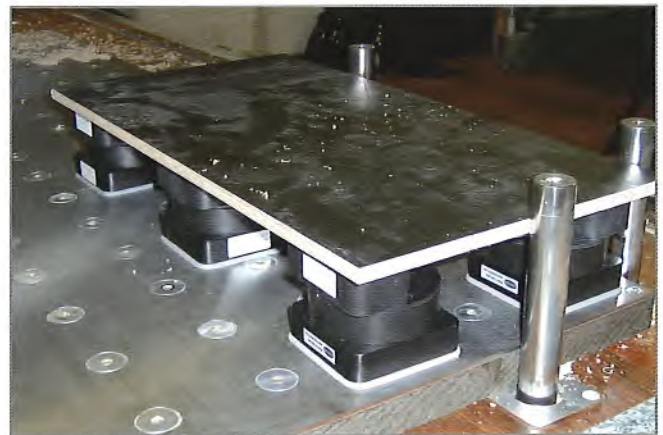
Innospann Steel-Plate-T | Umrüstung Glatttisch durch Steel-Plate-T mit Mono-Bases und diversen Sauger-Cups, Montage auf Raster-Zwischenplatte
