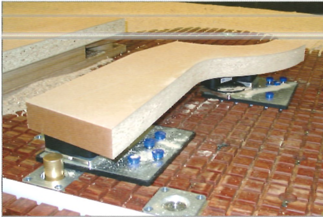
Innospann Rastertischsauger, frei positionierbar auf der Mini-Plate ISMP-R
