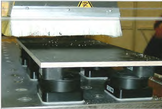
Innospann Steel-Plate-T mit Mono-Bases und Sauger-Cups
