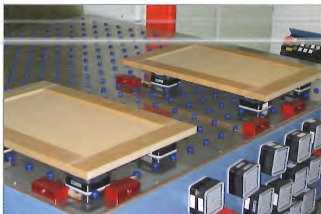
Innospann Steel-Plate mit Mono-Bases und Sauger-Cups
