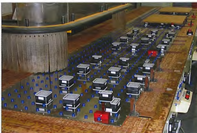
Innospann Steel-Plate | Umrüstung Rastertisch durch Steel-Plate mit Mono-Bases und diversen Sauger-Cups
