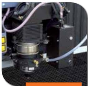
magnetisch befestigter Schneidkopf
