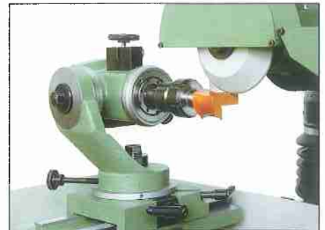
Spannzangenfutter MK 4 / M 16 zur Aufnahme von Schaftwerkzeugen mit zyl. Schaft Collet chuck MC 4 / M 16 for reception of shank type tools with cylindrical shank Fourrage de contraction MK 4 / M 16 pour admission d'outils à tige cylindrique
