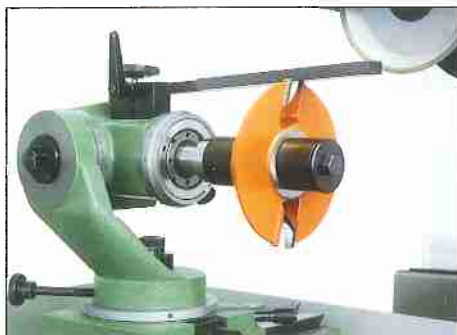
Einstelllineal zur Montage auf Teilapparat, für Span- und Freiwinkel Alignment guide used with dividing head for hook and clearance angle Règle de réglage pour montage sur partie d'appareil, pour angle de contraction et angle libre
