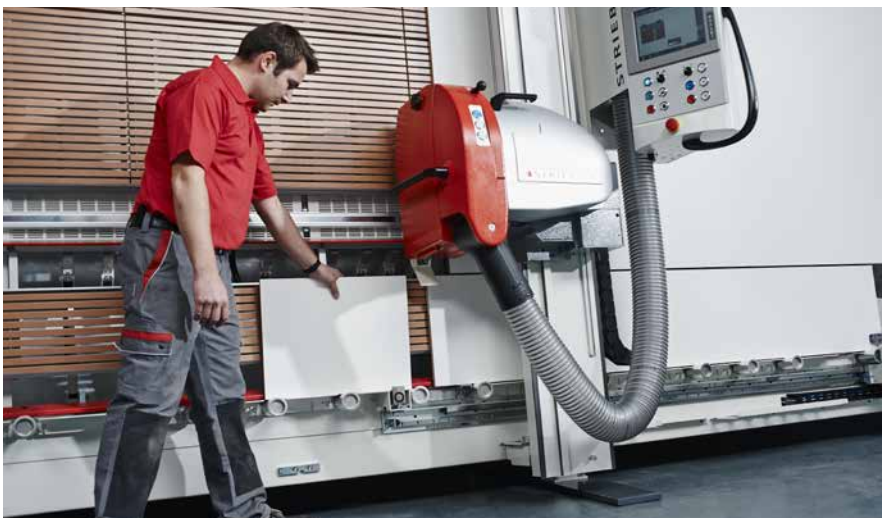
Une des multiples fonctions de la Striebig 4D : l'orientation automatique du moteur. Elle aide au processus de sciage entièrement automatisé et facilite grandement le travail de l'opérateur
