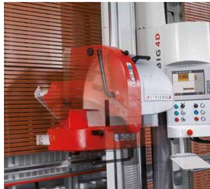
Une des multiples fonctions de la Striebig 4D : l'orientation automatique du moteur. Elle aide au processus de sciage entièrement automatisé et facilite grandement le travail de l'opérateur
