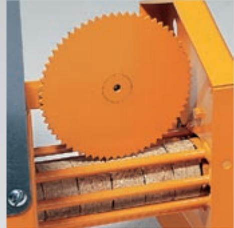
Elektronische Längenüberwachung der Presslinge über laufradgesteuerten Impulsgeber in Kombination mit Pressenabschaltung bei Materialende.
