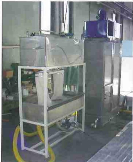
Camino d'aspirazione con separatore di gocce e skimmer di pulizia acqua in ricircolo con sistema di raccolta fanghi.
