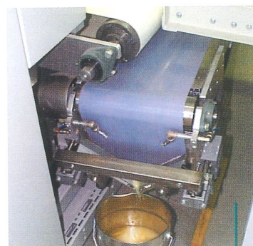
Das neue „Vband-Lackrückgewinnungssystem“
