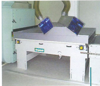
Teilansicht einer Trocknungsanlage mit UV-Härtung und vorgeschaltetem 6-Etagen-trockner
