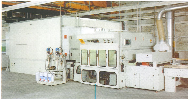
Spritzanlage mit Hochrockner
