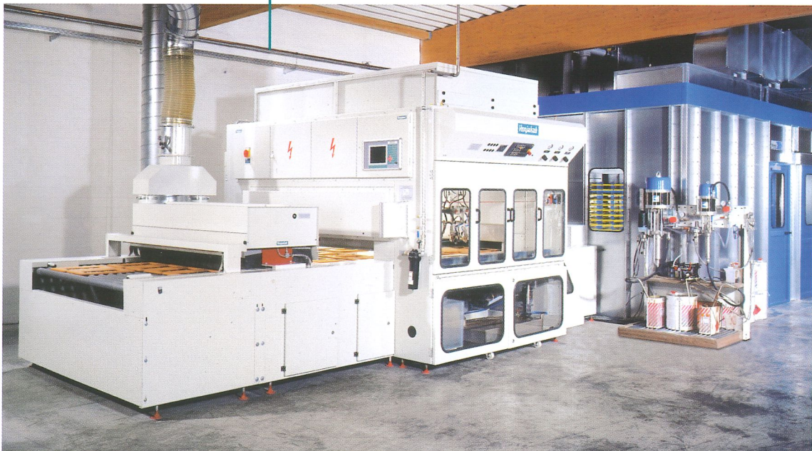
Flächenspritzmaschine Typ HGS-DUO/C mit angeschlossenem Reinraum
