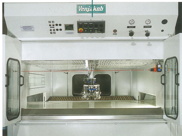
Flächenspritzmaschine Typ HGS/Z
