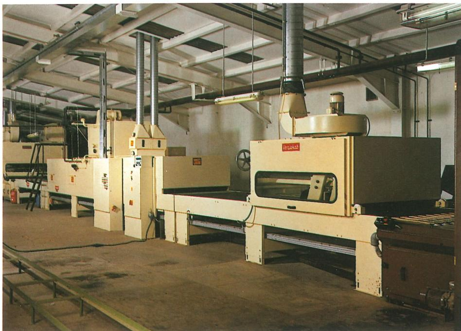
Eine Beizevertreibmaschine nach einer Flächenspritzmaschine. Nachfolgend ein Düsentrockenkanal und eine weitere Spritzmaschine für Lack.
