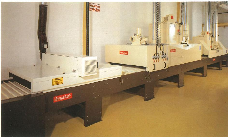
UV-Trocknenkanal / Infrarot-Zone / Düsentrockner / Abdunstkanal
