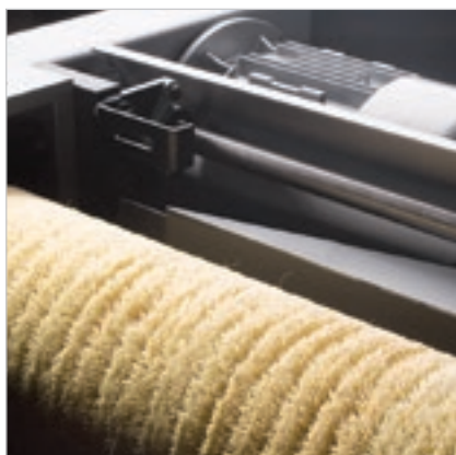
板材清洁刷可以安装不同材质的刷毛，以满足最严格的经加工板材清洁要求。
