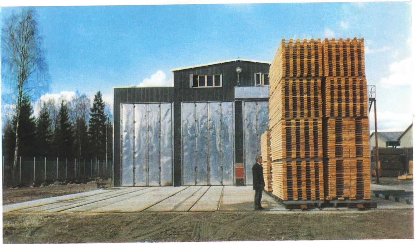
Großraum-Trockenstation mit Stapelhöhe bis 6,5 m, Nutzinhalt 600 m<sup>3</sup>
