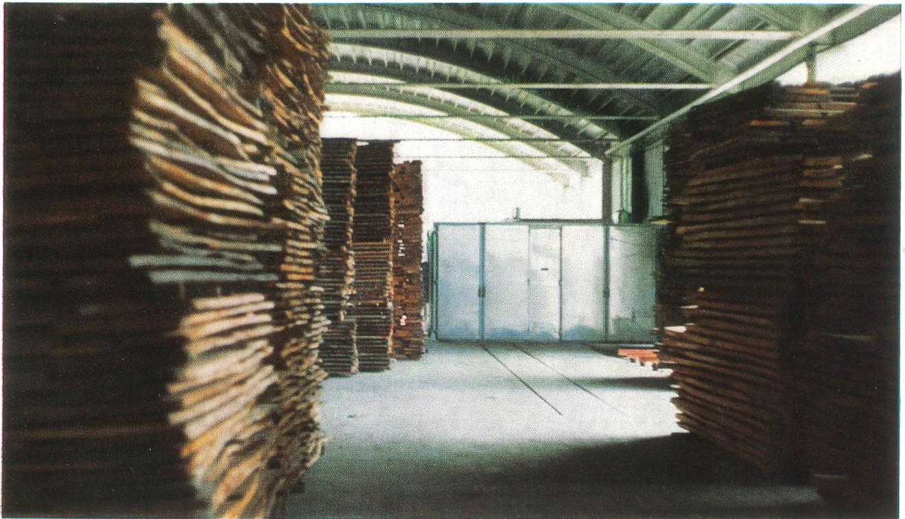
Trockenanlage in Aluminium-Segmentbauweise, Nutzinhalt 60 m<sup>3</sup>
