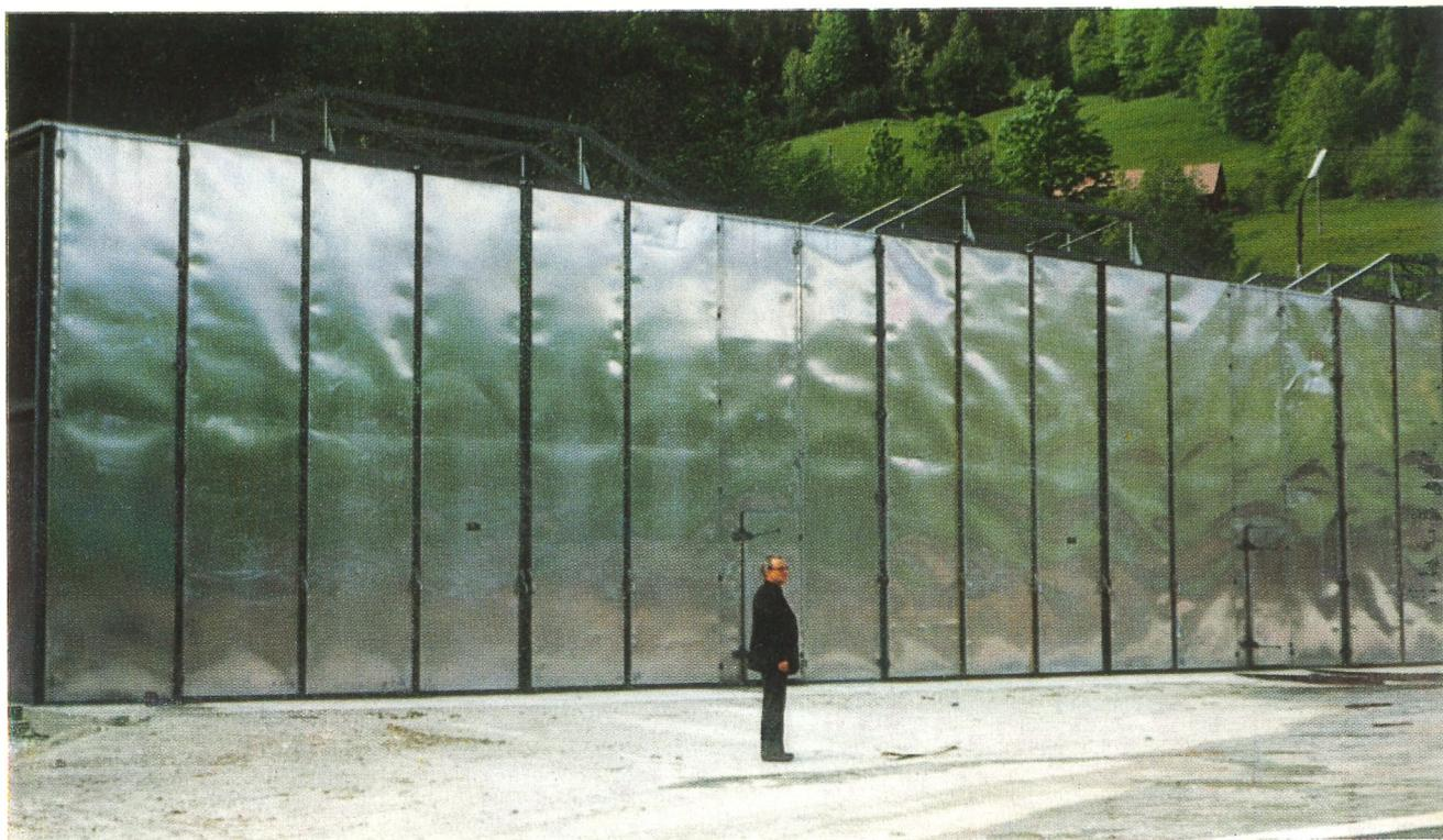
Frontbeschickte Alu-Kammern in Reihenaufstellung. Nutzinhalt  $4 \times 100 \text{ m}^3$ .
