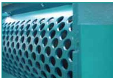
La taille des copeaux de bois est déterminée par un tamis installé d'origine. L'utilisation future des copeaux de bois va permettre de définir la taille des trous du tamis.
