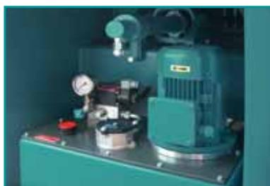
Le groupe hydraulique fait partie intégrante de la machine. Le cylindre hydraulique est placé dans un cardan, ce qui lui garantit une durée de vie plus longue.
