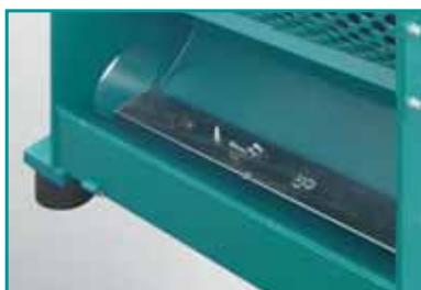
Tout corps étranger métallique tels que les clous, vis et agrafes métalliques sont expulsés après le broyage par l'action d'un aimant. Celui-ci n'est pas installé de série mais peut être rajouté en tant qu'option.
