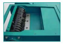
Door middel van de standaard gemonteerde schuif wordt het materiaal tegen de rotor gedrukt. De afstrijker verhindert dat dun materiaal zich tussen de schuif en de machinetafel klemt.
