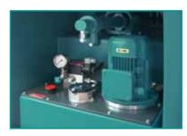
Het hydraulisch aggregaat is volledig in het machineframe geïntegreerd. De hydraulische cilinder is cardanisch gelagerd, waardoor een lange levensduur gegarandeerd is.
