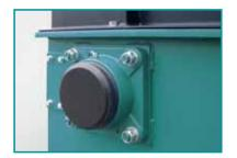
Nieuw ontwikkelde flenslagers garanderen een lange levensduur.
