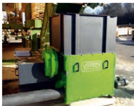
Links: EZ 10/2 mit 37 KW, Befüllung mit Restholz über Förderband, Materialaustrag mit Austragsschnecke zum Kratzbodenförderer.
