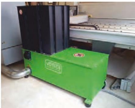
Oben: EZ 6/1 neben einer Plattenaufteilsäge zur Zerkleinerung von Spanplatten- und Multiplex-Platten Resten.
