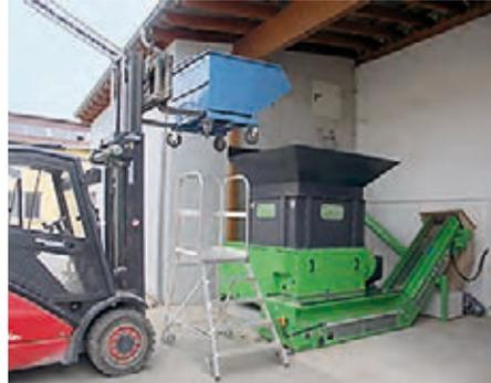
Einwellenzerkleinerer Baureihe EZ 13 spiegelverkehrt, (Getriebe ist an der rechten Seite angebracht) mit Förderband und Schnecke.
