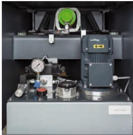
Das Hydraulikaggregat ist vollständig im Maschinenkörper integriert. Der Hydraulikzylinder ist kardanisch gelagert, wodurch eine lange Lebensdauer sichergestellt wird.
