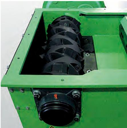
Über den serienmäßig installierten Hydraulik-Schieber wird das Material lastabhängig gegen die Rotorwelle gedrückt. Die Abstreiferleisten verhindern, dass dünnes Material sich zwischen Schieber und Maschinentisch verklemmen. Neu entwickelte, robuste Flanschlager gewährleisten hohe Lagerstandzeiten.
