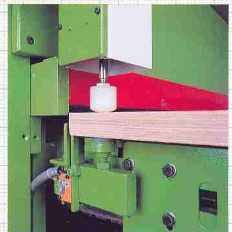
Automatische Werkstück-Dickenmessung mit Anfahrtschalter für exakte Einstellung der Tischöffnung.
