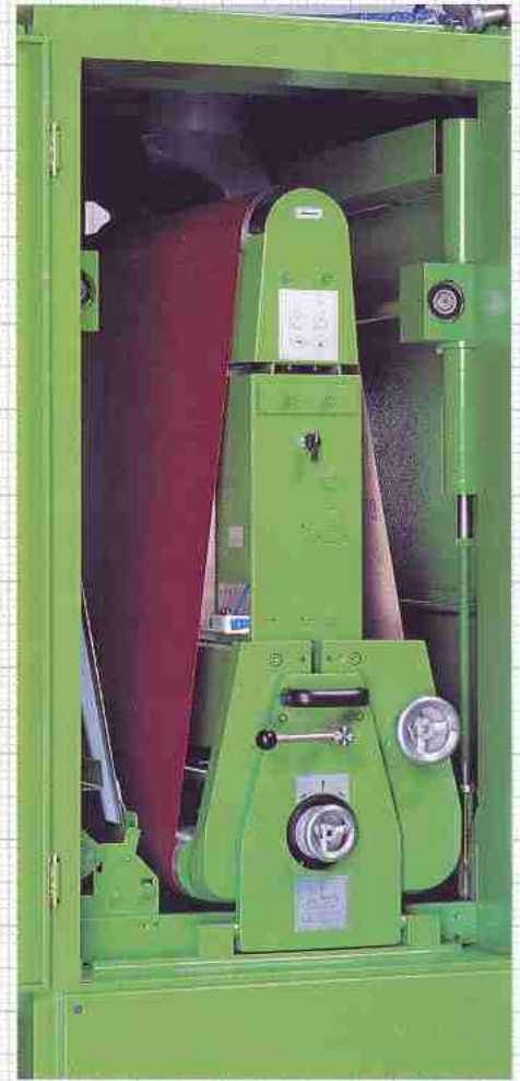
Kombistation mit mechanisch gesteuertem Schleifkissen. Höhenverstellbare Kontaktwalze. Andruck des Werkstückes durch schwenkbare Druckrollen und Federblech vor der Schleifstation.
