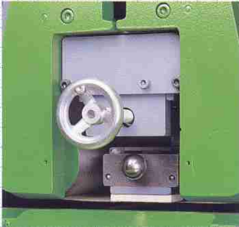
Schleifkissen 80 mm breit, mechanisch gesteuert. Spanabnahme über Handrad einstellbar.
