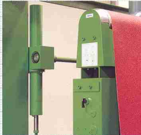
Zentrale Höhenverstellung über Spindel und Schneckentriebe. Robust, präzise, wartungsfrei.
