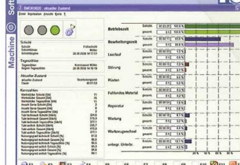
■ Zusätzliche Aufschlüsselung der IST-Einsatzzeiten (z.B. Produktionszeit, Rüstzeit etc.) ■ Aufschlüsselung der Unterbrechungszeiten ■ Schichtverwaltung und Schichtprotokollierung
