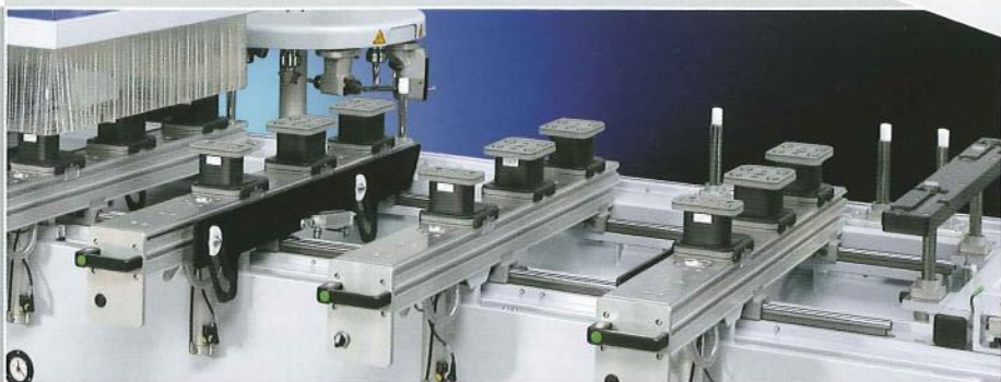
Integrierte LED-Leuchten zur Vakuumsaugerpositionierung
