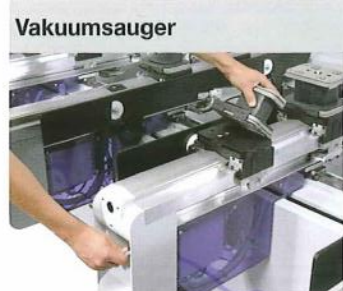
Vakuumsauger Einfaches Austauschen der verschiedensten Vakuumsaugertypen
