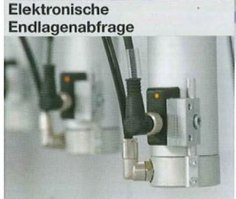
Elektronische Endlagenabfrage Erhöhte Sicherheit durch eine elektronische Endlagenabfrage an allen vorhandenen Anschlagzylindern.
