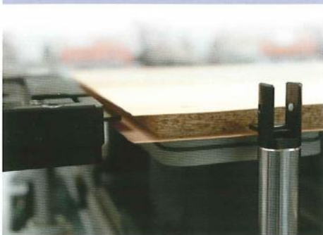
Gewährleistet einfaches Positionieren bei Material mit Furnierüberstand
