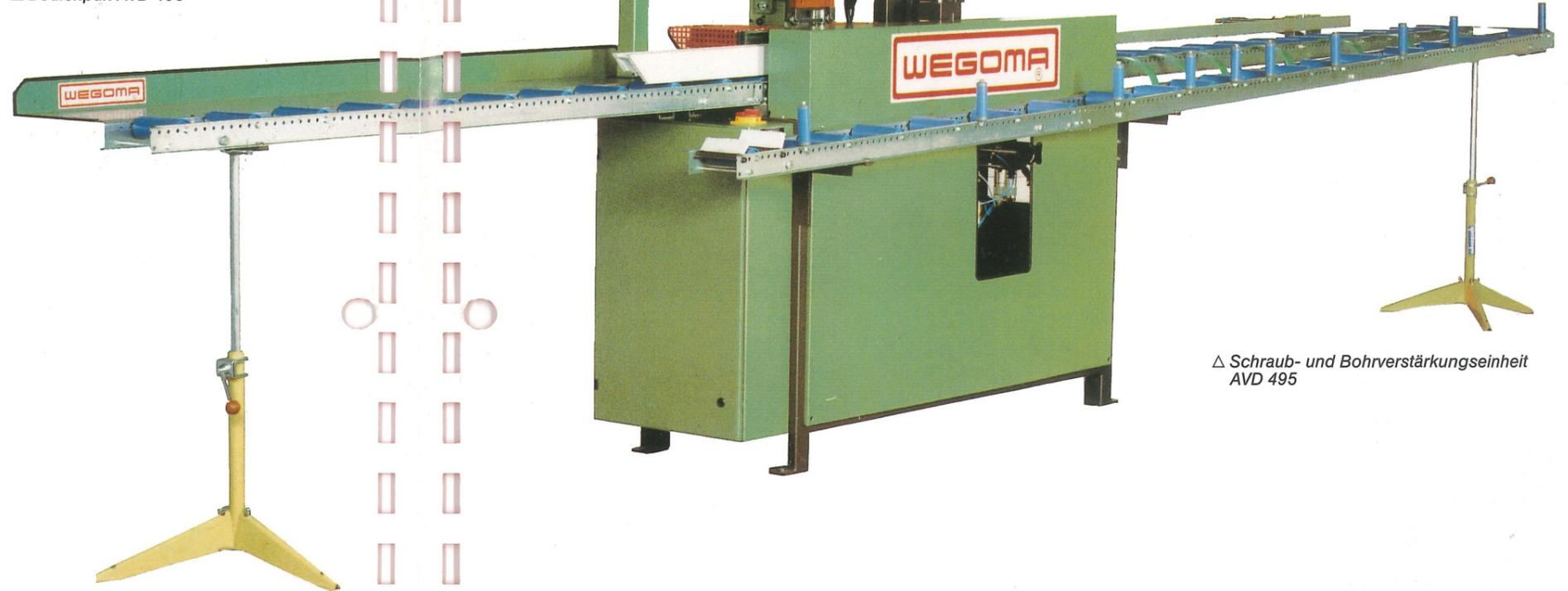
△ Schraub- und Bohrverstärkungseinheit AVD 495
