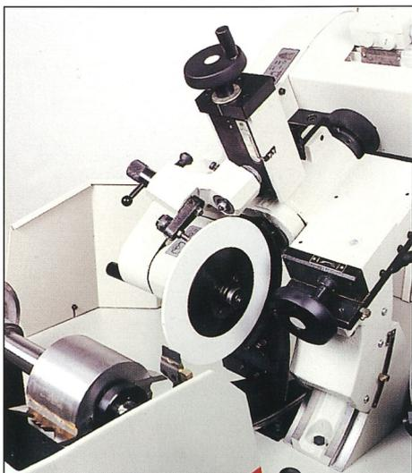
Die Freiwinkel an Rücken und Seite stellen Sie durch einfaches Schwenken der Schleifscheibe ein. Ihr Rondamat überträgt die Form des Kopierstifts mittels Diamant auf die Schleifscheibe. Diese wird mechanisch gespannt: rasches und wiederholgenaues Wechseln!
