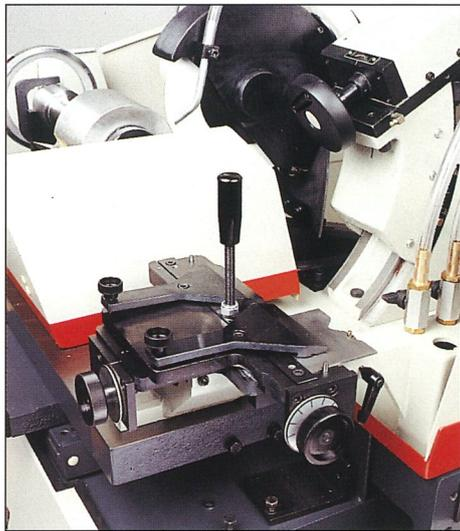
Einfach die Profilschablone in den Rondamat einsetzen. Wenige Minuten später haben Sie Ihre Profilmesser. Alle Schneiden absolut gleich! Weil die Messer im Messerkopf geschliffen werden.
