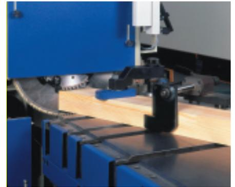
Schrägfensterfertigung ohne Aufriss: Die Informationen für die Winkel- und Längeneinstellung des elektronischen Längenschlagsystems werden aus der Kunden-EDV per Online oder Diskette übertragen und am Bildschirm angezeigt. Mit dem Laser-Richtlicht an der Ablängsäge wird der Sägeabschnitt markiert. Die seitliche Zusatzklemmung gewährt eine optimale Teilespannung.
