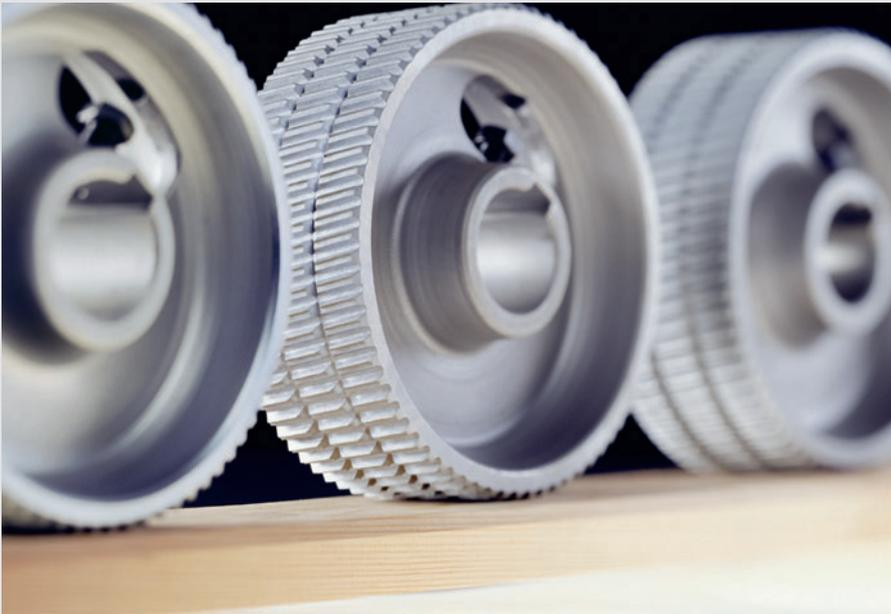
Dans l'usinage du bois, du MDF ou des matières synthétiques, le système d'entraînement WEINIG se porte garant d'un produit fini impeccable. Les rouleaux supérieurs chromés à denture spéciale et les rouleaux entraînés dans la table, qui peuvent être montés de manière variable, assurent un transport continu des pièces à usiner. L'entraînement par cardan sans chaînes est robuste, d'une longue durée de vie et ne requiert pratiquement pas d'entretien.
