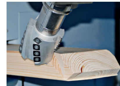
Herstellen eines Zapfen
