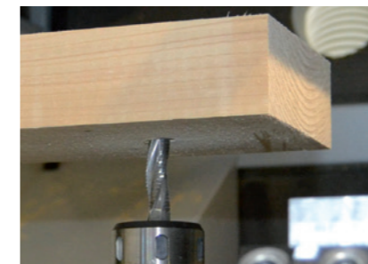
Zapfenloch-Fräsung mit Unterfluraggregat
