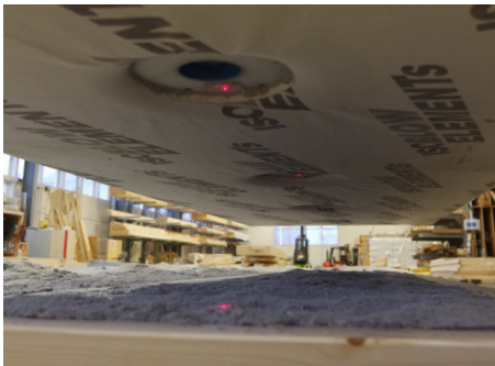
Automatische Berechnung der Füllmenge für optimale und gleichmäßige Dichte-Verteilung der Dämmung pro Fach.
