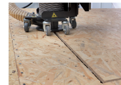
WALLTEQ M-320: полностью автоматическая обработка с использованием фрезерного агрегата
