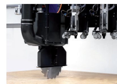
Пильный агрегат со встроенным защитным кожухом и вытяжным колпаком
