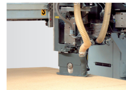
WALLTEQ M-300: полностью автоматическая обработка с использованием пильного агрегата
