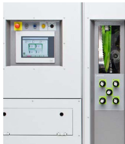
高科技碳枕式锯条导向设计极具抗磨损能力
