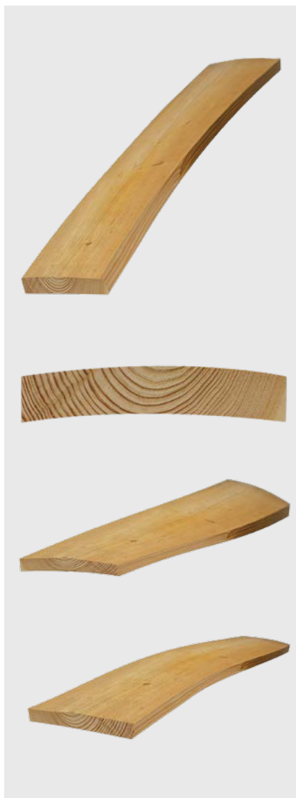
Blocs avec voilement longitudinal ou transversal, bombage ou gauchissement
