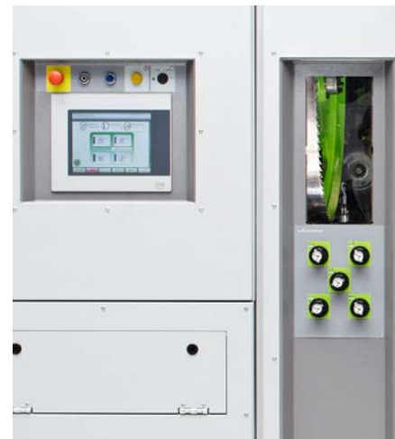
Guide lame à pression au carbone extrêmement résistant à l'usure
