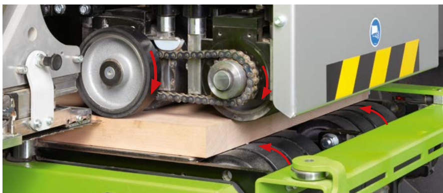
Rouleaux de transport motorisés supérieurs et inférieurs
