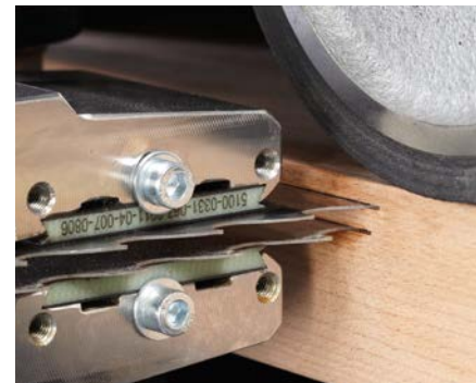
Guide lame à pression au carbone extrêmement résistant à l'usure
