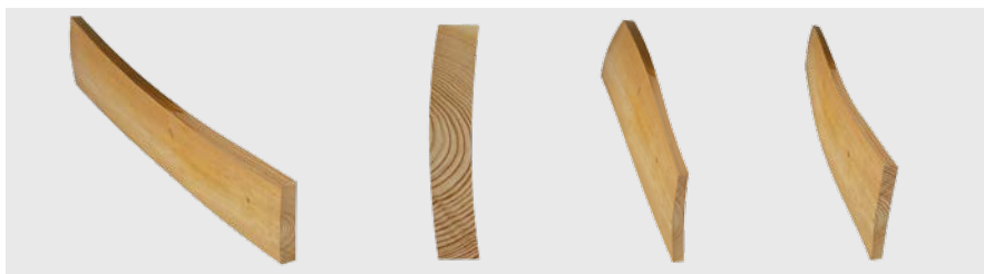
Blocs avec voilement longitudinal ou transversal, bombage ou gauchissement
