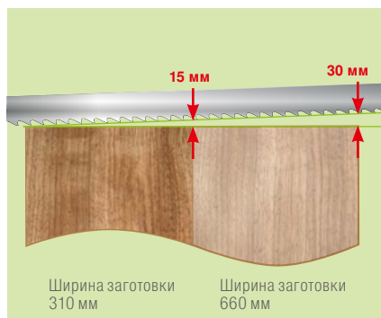
Наклонное положение > 2^\circ уменьшает максимальную ширину пропила
