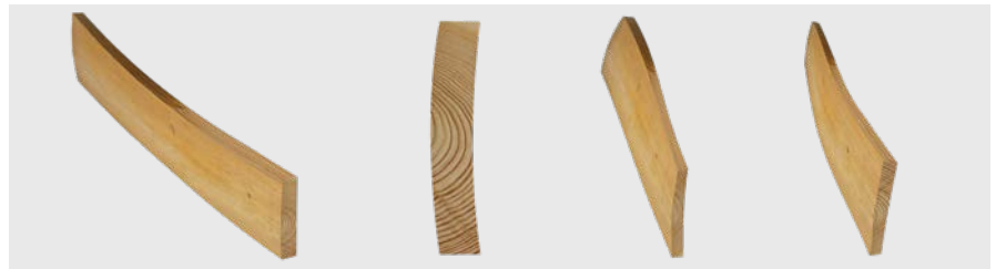
Bloques con alabeos longitudinales o transversales, deformaciones o curvaturas
