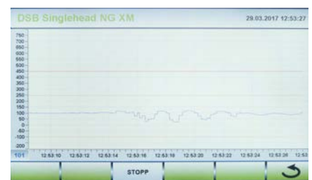
Supervisión controlada por sensores de las sierras
