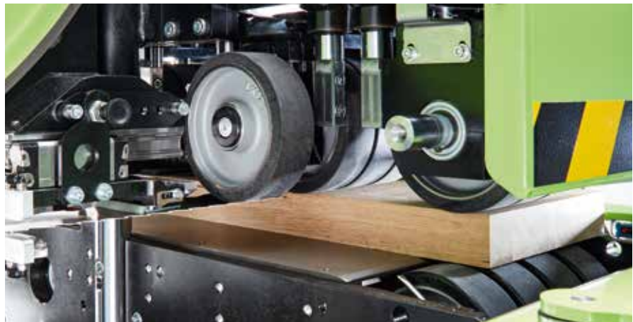
Rouleaux de transport motorisés supérieurs et inférieurs
