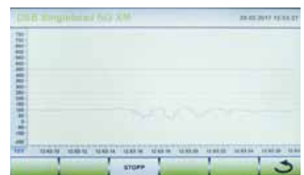
Surveillance du sciage contrôlée par des capteurs
