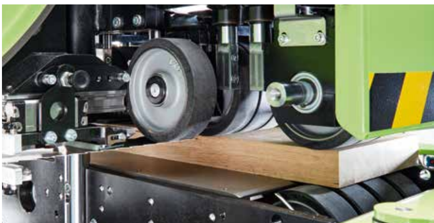
Rulli di trasporto superiori e inferiori motorizzati
