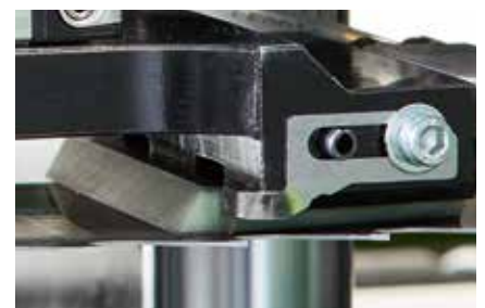
Guida in carbonio "high-tech" estremamente resistente all'abrasione
