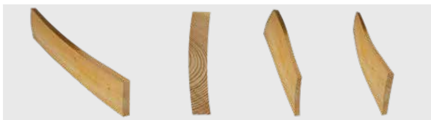
Blocos com curvatura transversal ou longitudinal, empeno ou torção
