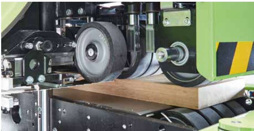
Приводные роликовые транспортеры в верхней и нижней части
