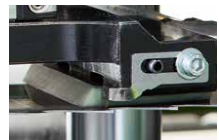
Экстремально устойчивая к износу высокотехнологичная карбоновая направляющая
