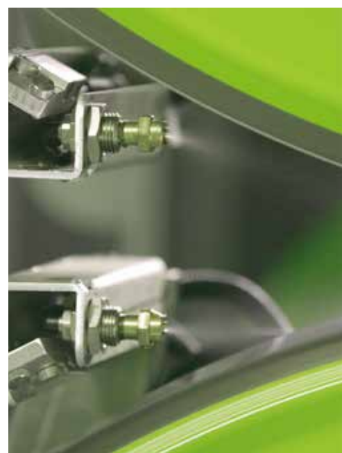
Sistema de pulverización para corte en húmedo
