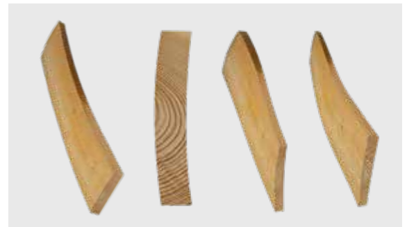
Bloques con alabeos longitudinales o transversales, deformaciones o curvaturas
