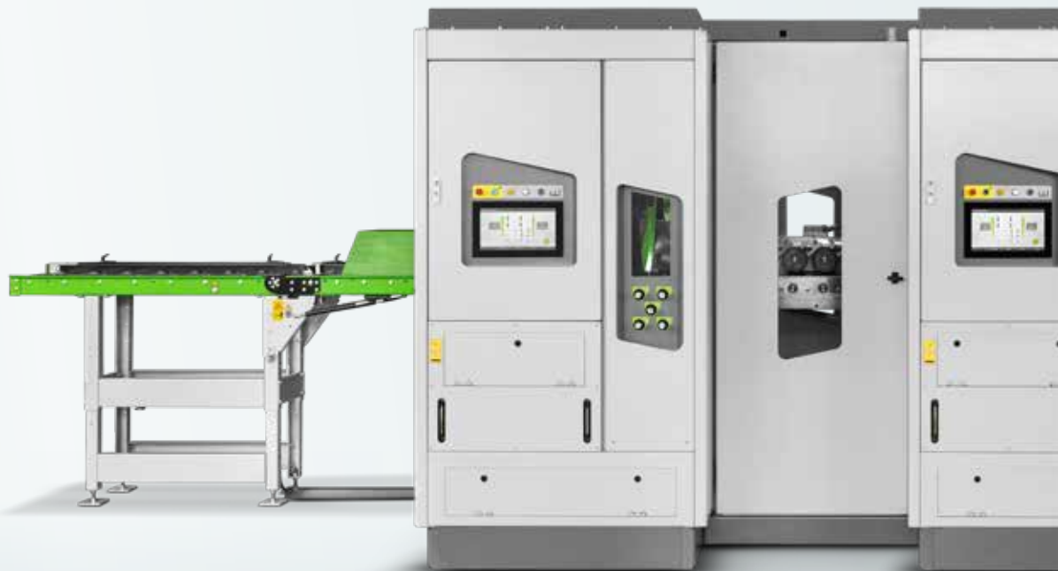
3 DSB Twinhead Pro XM collegate in serie con un totale di 6 moduli sega
