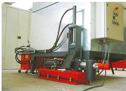
Brikettierpresse der Baureihe TH 400 - TH 700, Behältergröße 1.400 x 1.400 x 1.250 mm
