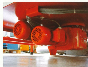
Brikettierpresse der Baureihe TH 400 - TH 700, Behältergröße 1.400 x 1.400 x 1.250 mm
