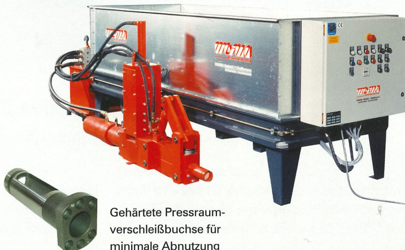
Brikettierpresse der Baureihe TH 600, Behälter mit Schubbodenaustragung
