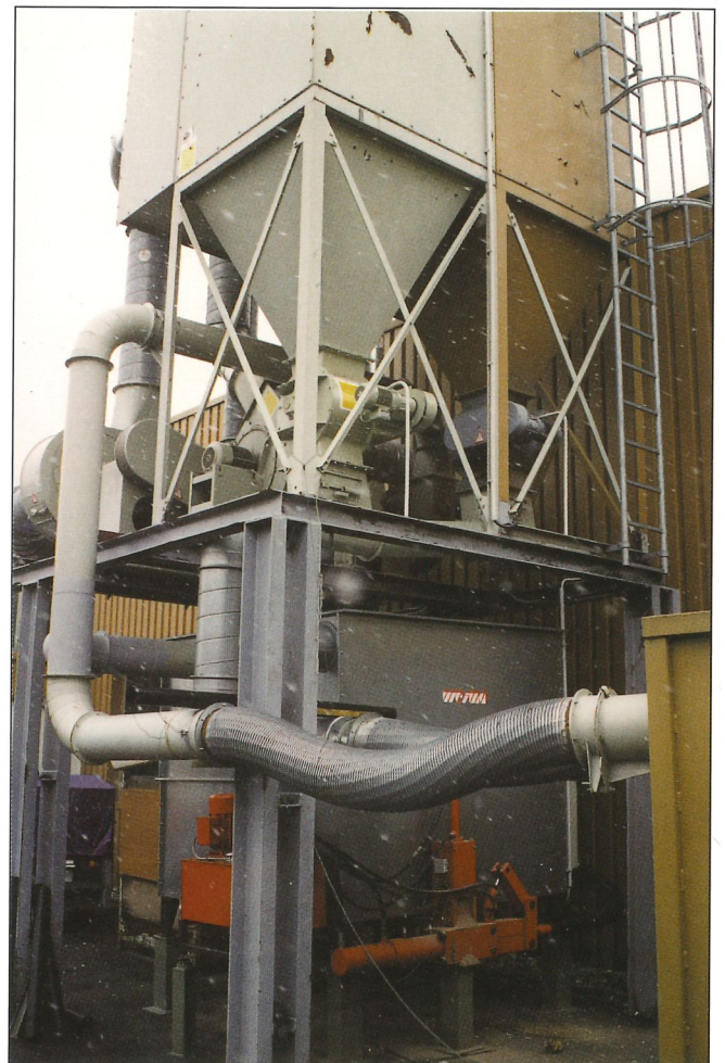
Individuelle Entsorgung mit einer WEIMA- Brikettierpresse
