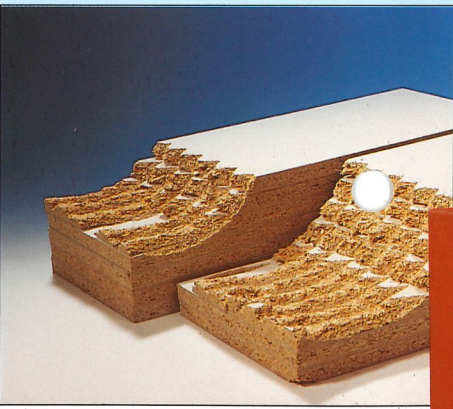
Rotor-Ø 368 mm, grand rotor et angle de coupe importante permettent un gros débit surtout avec des matériaux à broyer en forme de panneaux.
