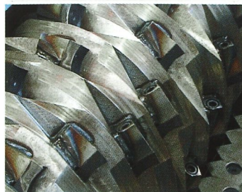
V-Rotor mit zwei Messerreihen
