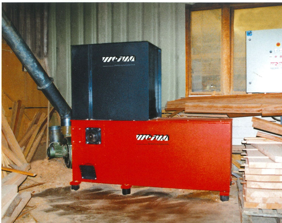
Zerkleinerer der Baureihe WL 4 S, angeschlossen an eine Absauganlage
