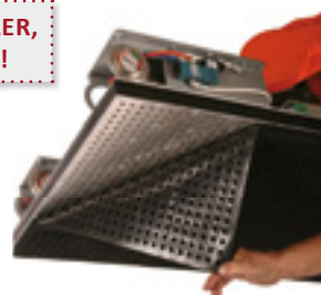
Austausch der Saugmatte ohne Werkzeug
