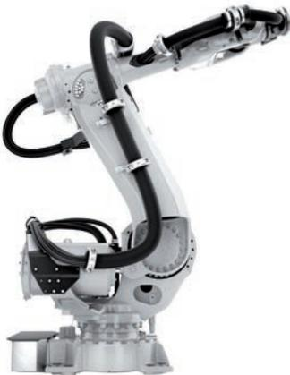
LeanID ist eine spezielle Ausführung für den IRB 6640, bei der das Schlauchpaket (DressPack) teilweise in den Oberarm des Roboters integriert ist. LeanID wurde speziell für Anwendungen entwickelt, bei denen der Roboter komplexe Handgelenksbewegungen ausführen muss und es einen großen Bedarf an Flexibilität bei Produktwechseln gibt. Roboter in LeanID-Ausführung haben aufgrund des größeren Offsets der 6. Achse eine geringere Handhabungskapazität.
