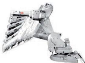
Basierend auf einem hochentwickelten dynamischen Modell optimiert die IRC5-Steuerung die Roboterleistung für die physikalisch kürzest mögliche Zykluszeit (QuickMove) und exakte Bahngenauigkeit (TrueMove). Zusammen mit einer geschwindigkeitsunabhängigen Bewegungsbahn, wird automatisch ein vorhersagbares und leistungsfähiges Roboterverhalten generiert, das keine Nachjustierungen seitens des Programmierers erfordert – der Bediener erhält das Programm, welches er tatsächlich auch programmiert hat.
