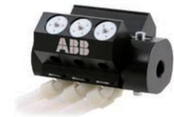
Die Farbwechsler von ABB sind speziell für schnelle Farbwechsel ausgelegt. Die inneren Bohrungen der Farbwechsler sind ohne „Toträume“ ausgeführt, wodurch die Reinigungszyklen auf ein Minimum reduziert werden. Die Einheiten sind in Kunststoff- sowie Stahlausführung erhältlich, mit oder ohne Rückführung. Sie sind kompatibel mit Lösungsmittel- und wasserbasierten Lacken, die in den 1K- und 2K-Systemen verwendet werden.
