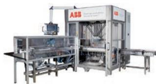
RacerPack ist eine Lösung für das Verpacken von Produkten in Schlauchbeuteln und dem anschließenden Ablegen der verpackten Produkte in Kartons. Diese Lösung beinhaltet die Produktzuführung, die Roboterzelle mit Greifern sowie das Auslaufförderband.
