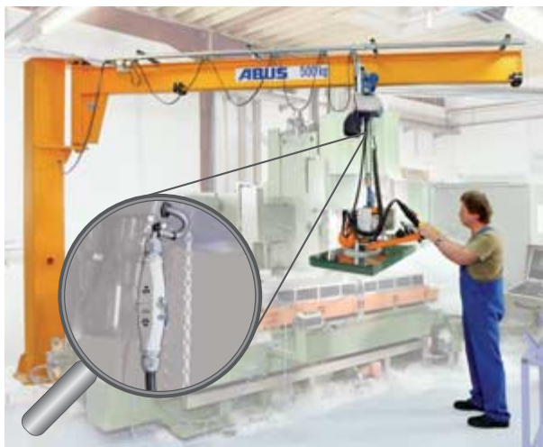
Schwenkran mit Vakuumgerät u. Stecker (Bild 13)
