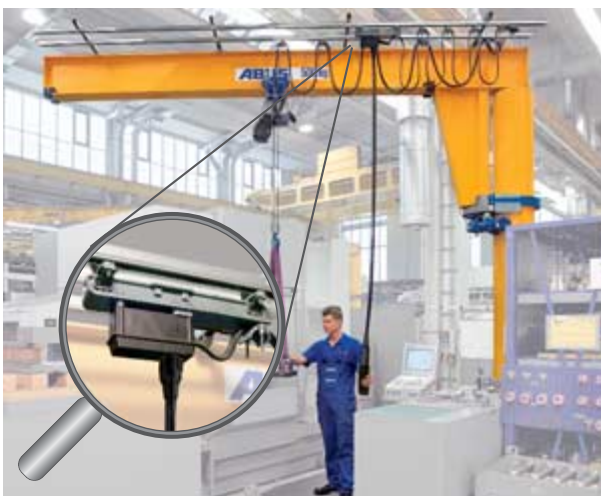
verfahrbare Steuerung (Bild 11)
