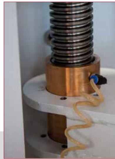
Sollevamento motorizzato dotato di quattro viti diametro 50mm e chiocchie in bronzo autolubrificate.
