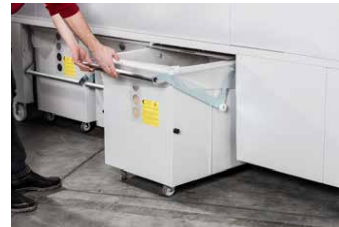
Spänebehälter wieder einsetzen und Staubschott entfernen
