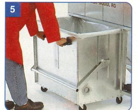
ort in der Werkstatt gefahren werden. Durch seine **rechteckige und schmale Bauweise (nur 67 cm breit)** braucht das kompakte Geräte wenig Platz, paßt durch schmale Gänge und in kleine Ecken. In der Werkstatt kann der AL-KO Mobilentstauber damit schnell von einem Einsatzort zum nächsten geschoben werden.
