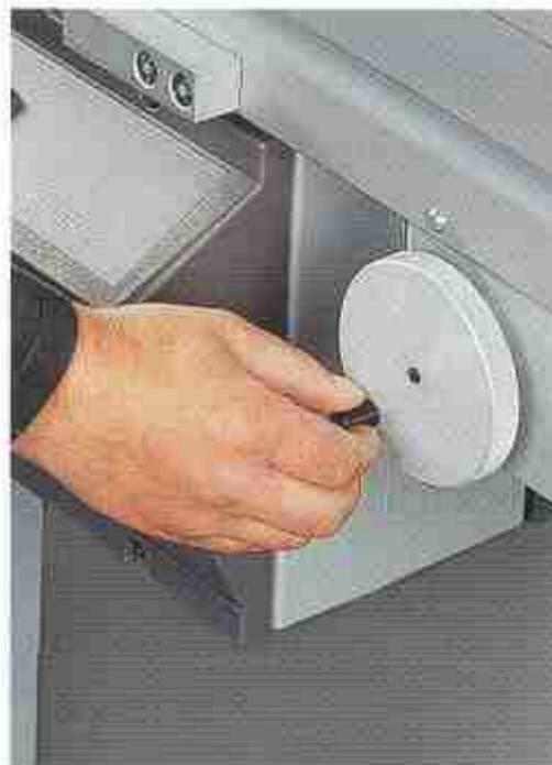
Das Verstellrad des DIGIT S ist bedienerfreundlich im Umfeld des Hauptbedienpanels angebracht. Die Bedienung denkbar einfach, schnell und exakt: Die Verstellschritte erfolgen in 1/10 mm Schritten. Der Bediener bestimmt selbst die Fahrgeschwindigkeit des Parallelanschlags. Wird das Stellrad langsam bewegt, bewegt sich der Parallelanschlag in der Minimalgeschwindigkeit des 1/10 mm Rasters.
