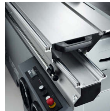
Знаменитая двухроликовая каретка Altendorf на стальных направляющих.
