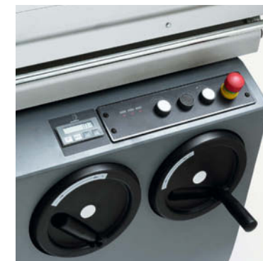
Ручная регулировка высоты и наклона пильного диска.
