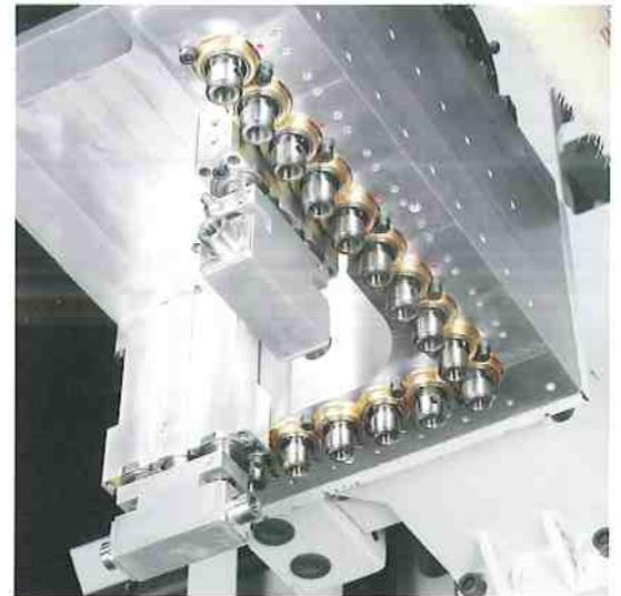
■ Das Bohraggregat verfügt über 16 vertikale Spindeln und über 2 doppelseitige horizontale Bohreinheiten.
