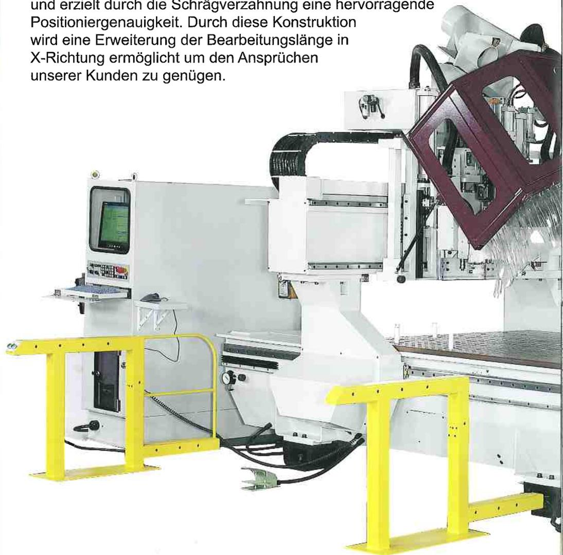
Die Maschine verfügt über 2 getrennte Vakuumzonen und Spiegelfunktion. Der Rasternutentisch aus HPL ermöglicht gemeinsam mit den automatischen Anschlägen vielfältige Spanntechniken.
